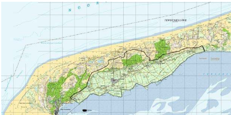
FIGUUR 43 De tweede dijkkring is aangelegd door natuurlijke duinen aan elkaar te koppelen middels kunstmatige ophogingen die in het landschap goed zichtbaar zijn.
